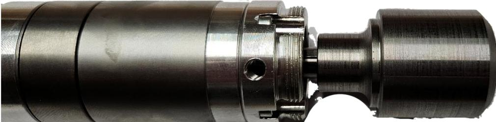
3. Drehen Sie den Freilauf, bis die Motorbefestigungsgewinde (M6-Gewinde) mit der Madenschraube ausgerichtet sind.
