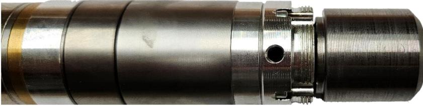
2. Drehen Sie den Freilauf um die Drehachse, bis die Löcher für die Motorbefestigungsschrauben (M6) mit dem Loch für die Madenschraube übereinstimmen (siehe Bild).
